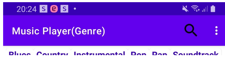
Figure 2.6: Die Darstellung einer ActionBar
