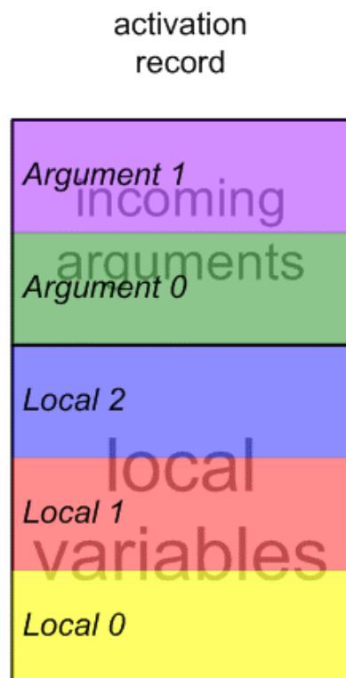
Abb.: Die Slots für die Argumente und lokalen Variablen der Methode TestMethod im Activation Record.
