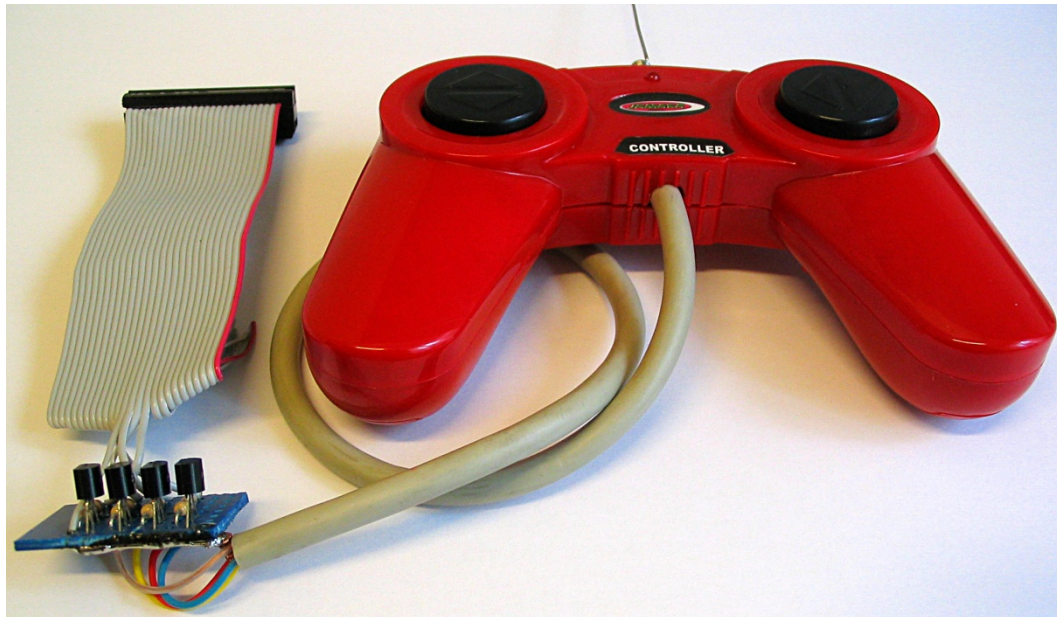
Abbildung 26: Fertig umgebaute Fernbedienung
